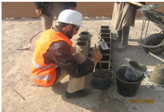
ریخت نمونه های مکعبی و استوانی برای تست مقاومت فشاری
