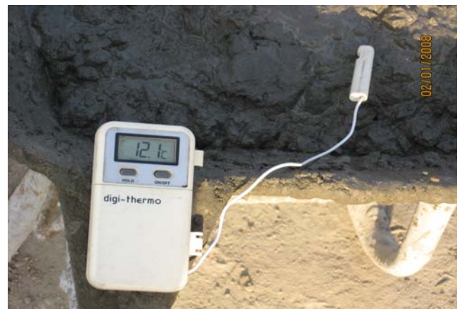
ترمامیتر نشان دهنده درجه حرارت کانکریت 12.1 درجه سانتی گراد
