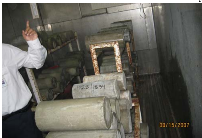
نمونه ها تحت مراقبت یا Curing در لابراتوار با رطوبت مورد ضرورت و درجه حرارت 25 سانتی گراد
