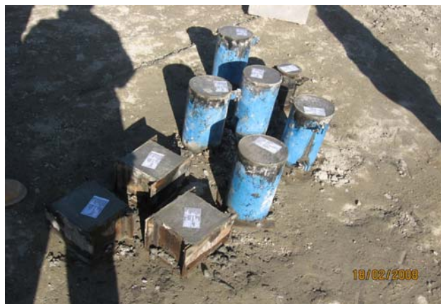
ریخت نمونه های مکعبی و استوانی برای تست مقاومت فشاری
