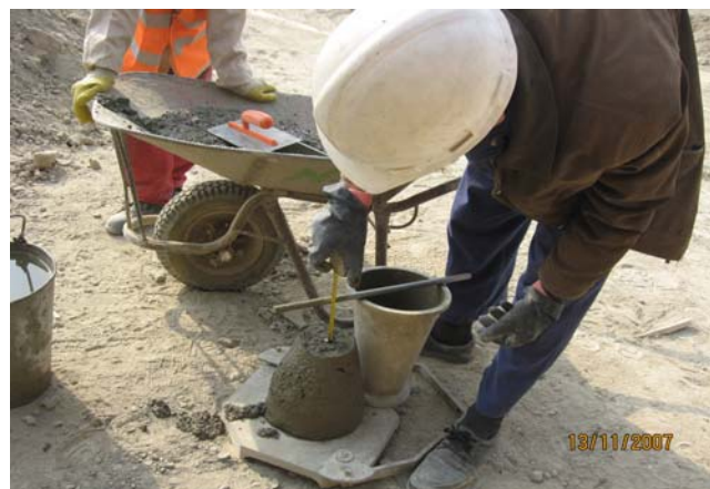
مرحله اندازه گیری سلمپ کانکریت
