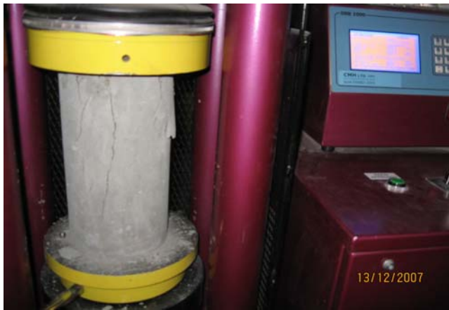
شکست نمونه استوانه ی تحت قوه فشاری
