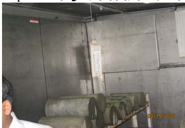
نمونه ها تحت مراقبت یا Curing در لابراتوار با رطوبت مورد ضرورت و درجه حرارت 25 سانتی گراد
