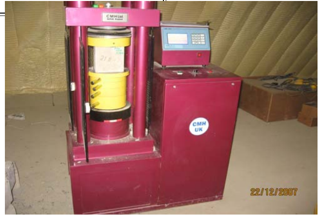
نمونه مکعبی تحت تست فشاری
