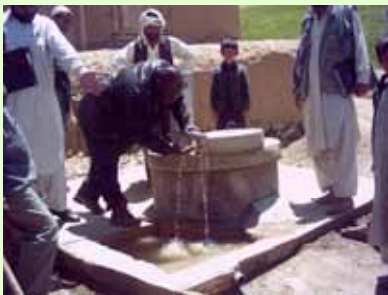
د څښناک د اوبو د انجنیرانو له خوا په بامیانو کې د وپستل شوی څاه د اوبو د کیفیت آزمویل.
