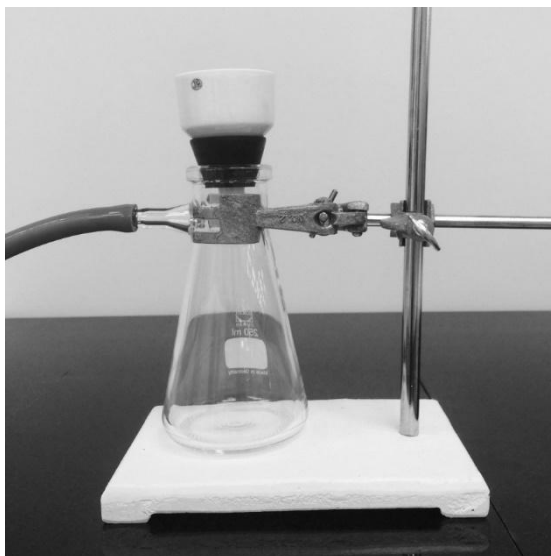
شکل ۲: نحوه سوار کردن وسایل برای صاف کردن به کمک خلاء
