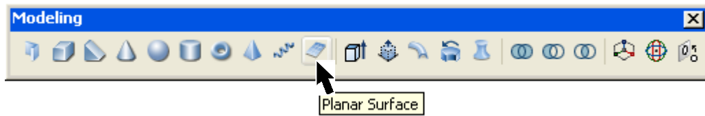
شکل د (۴۹-۱) (Modeling) منيو څخه د همواري سطحه (Planar Surface) د هد ايت غوره کول
