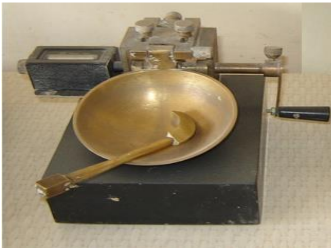
شکل - آله استاندارد با میله مخصوص آن که برای تست PI از آن استفاده میشود
